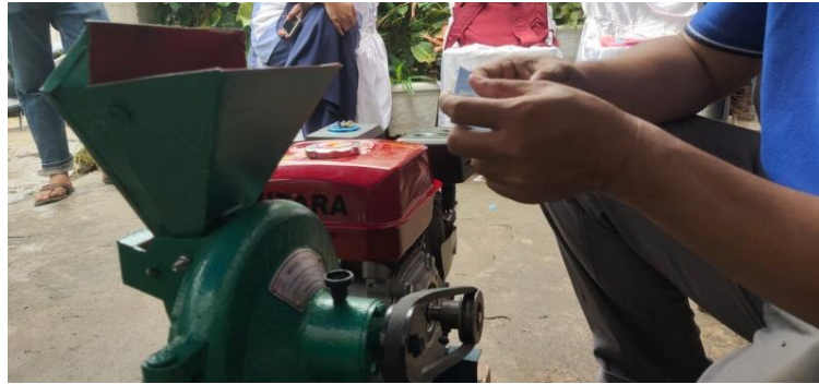
Gambar 4. Proses Penepung Pembuatan Gula Semut
