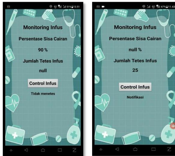
**Gambar 1. Sistem Pemantauan Cairan Infus Tampilan Smartphone**
