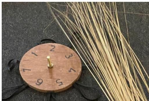
**Gambar 2. Alat Cetak Piring Lidi Sawit**
