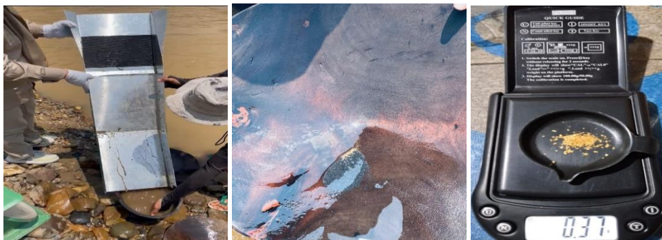
Gambar 6. Hasil pemisahan emas dari pengotornya dan timbangan hasil konsentrat emas
