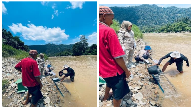
Gambar 5. Mitra mempraktekkan sendiri penggunaan sluice box
