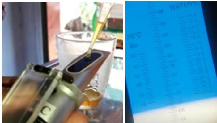
**Gambar 4. Pengujian dengan Fraktometer**
