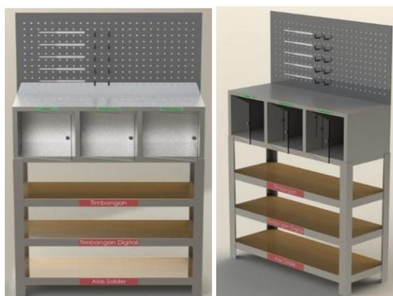
Gambar 11. *Shadow Board* Stasiun Kerja Pengemasan
