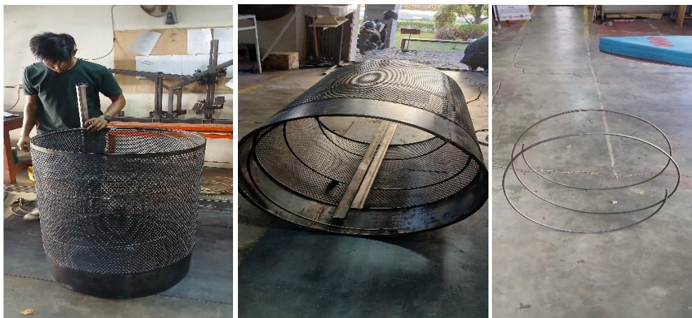
Gambar 5. Pembuatan Drum Penyikat
