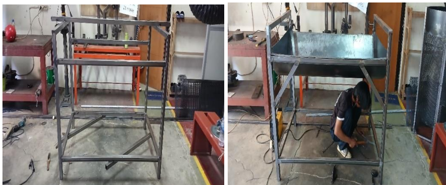
Gambar 6. Pembuatan Rangka dan bak Penampung
