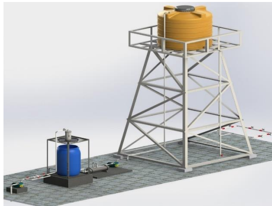
Gambar 3. Desain Mesin Pengolahan Air
