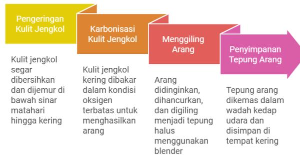
**Gambar 7. Proses Pembuatan Tepung Arang dari Kulit Jengkol**
