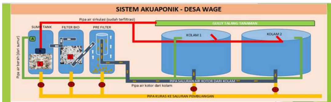
Gambar 2. Rancangan sistem akuaponik Pokmas Tsadewa
