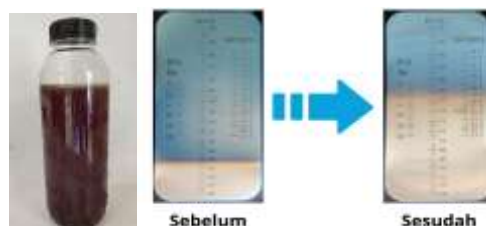
Gambar 5. Madu kelulut hasil destilasi dan hasil pengukuran kualitas madu kelulut dengan alat refraktometer madu
