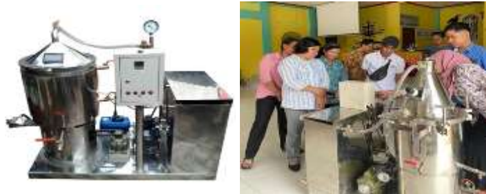
Gambar 4. Unit destilasi DVSR (a) dan praktek penggunaan alat destilasi madu kelulut (b)
