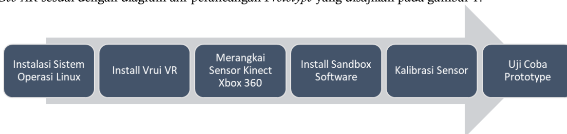
Gambar 1. Alur pembuatan Prototype Geo-AR
