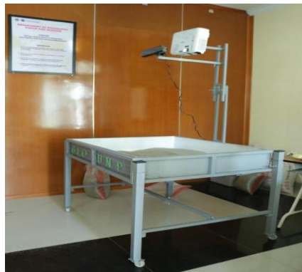
Gambar. 2. Susunan proyektor dan sensor untuk memproyeksikan warna di atas pasir.
