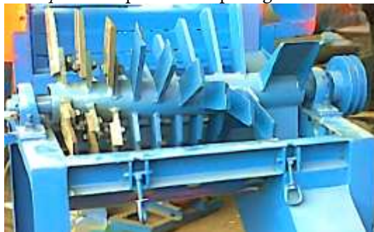
Gambar 7. Mekanisme pencacahan Strip Blade
