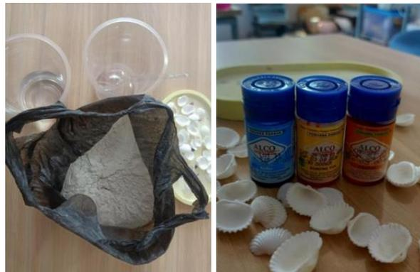
**Gambar 5. Bahan pembuatan terrazzo dengan campuran cangkang kerang**
